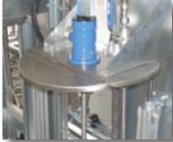
LZL-Druckluftmotoren zählen zu den derzeit leichtesten und leistungsstärksten Antrieben für Rührwerke und Mischanlagen.
